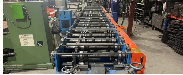
Máy Cán Biến Dạng Mâm St Chính Biến Dạng Tự Động
