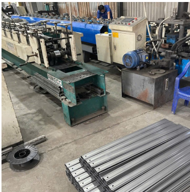
Máy Cán Biến Dạng Thanh Giằng Kệ Hạng Nặng Tự Động
